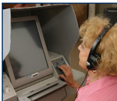
Este dispositivo para marcar las boletas utiliza una boleta de papel de escaneo óptico. Proporciona a los electores con discapacidades la opción de una función de audio con audífonos, un teclado en Braille, una función de letras grandes, un dispositivo de inhalación y exhalación y un dispositivo de dos pedales.
